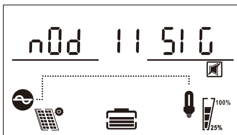
主显示页面11：并机状态，3KVA无此页面，仅针对5KVA机型
